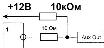
Электрическая схема выходного каскада программируемого выхода представлена на Рис. 3. Ток, отдаваемый в нагрузку каскадом, не превышает 250 мкА в состоянии логической [1] (высокий уровень), и 25 мА - в состоянии логического [0] (низкий уровень).
